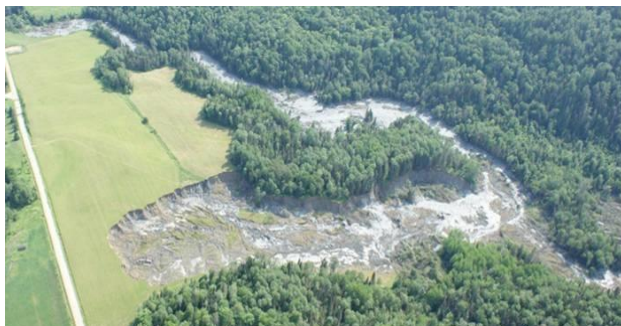
Figure 6. Exemple d'une coulée argileuse avec des sols très remaniés et un fort écoulement des débris hors de la cicatrice (source : MTQ, 2010).
