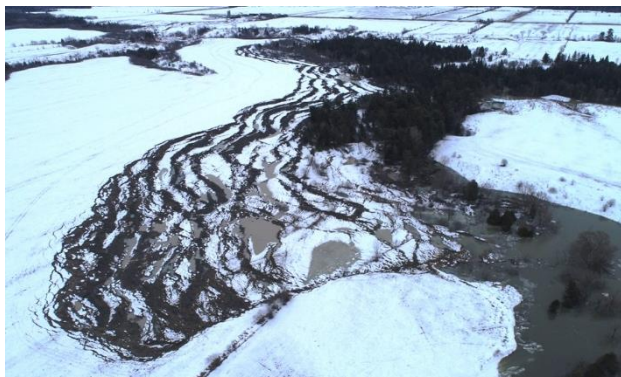
Figure 7 : Exemple d'un glissement de type étalement dans des sols argileux, dont les dimensions sont de l'ordre du kilomètre (Brownsburg, 28 mars 2018).
