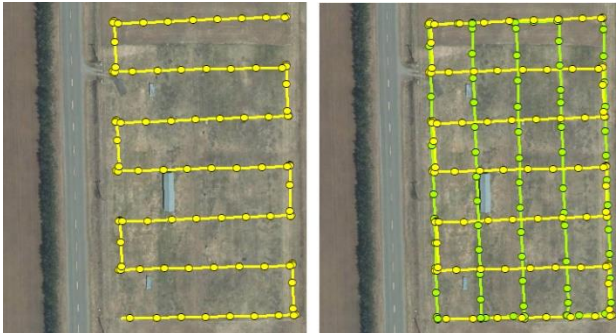
Figure 11. Patrons de prise de vue en simple (à gauche) et en double recouvrement (à droite).
